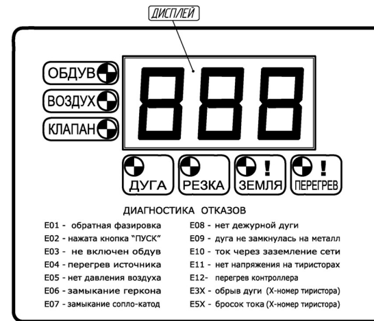
Рисунок 2 Панель управления, зона световой индикации контроллера
